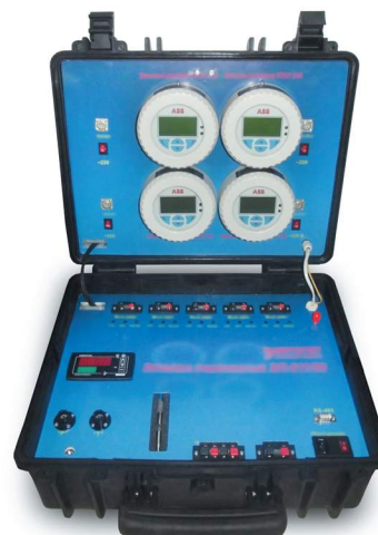
Рис. 1 - Внешний вид составной части единицы расхода жидкости эталона-переносчика производства фирмы ABB типа HygenicMaster FEH521
